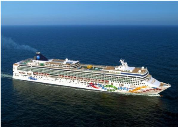
Dieses Schiff wurde, wie die übrigen seiner Klasse der so genannten Panmax-Klasse (Schiffe, die noch durch den Panama-Kanal passen) in der Größe von ca. 180 Tausend Bruttoregistertonnen (1 BRT = 3,25 m<sup>3</sup>) aus ca. 70 vorgefertigten Blöcken zusammengesetzt. 1 Block wiegt dabei rd. 700 Tonnen. Im größten Laserzentrum Europas werden mo-
